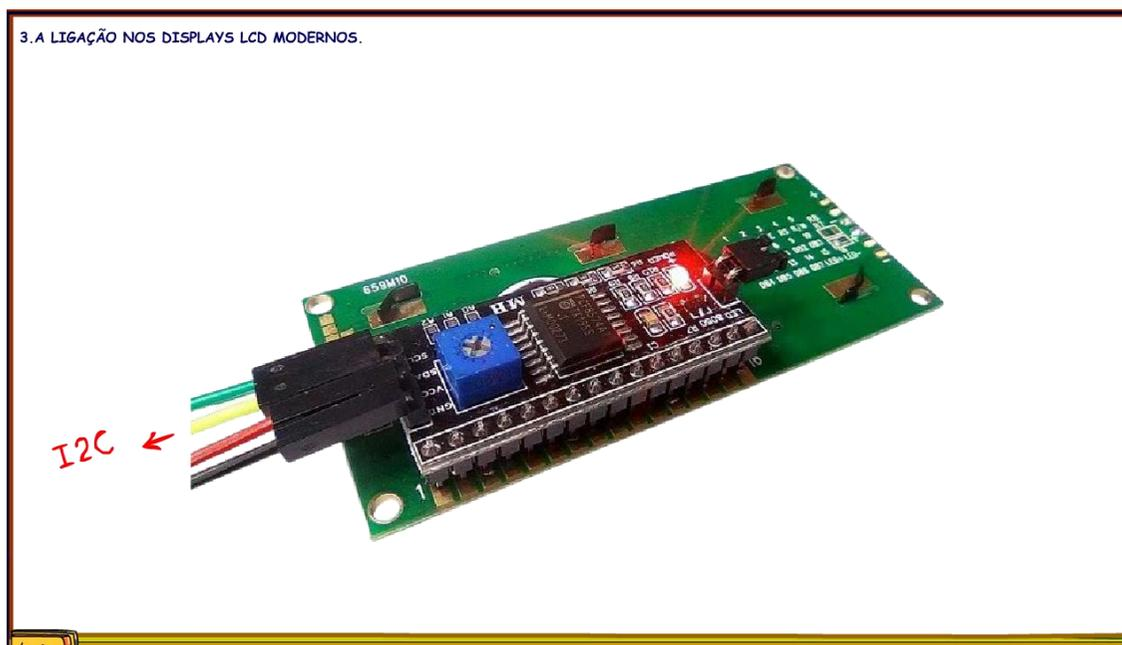
Se você tem um display moderno com 16 pinos, como o da figura, os pinos do módulo encaixam perfeitamente, é só colocar um do lado do outro e fazer as conexões, ou melhor ainda soldar o módulo I2C direto no display, os pinos são perfeitamente compatíveis, aí é só completar a ligação da conexão I2c.
