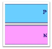
Agora você já sabe que o cristal tipo P conduz corrente elétrica devido as cargas positivas e o cristal tipo N conduz devido aos elétrons livres, as cargas negativas, então, eu não vou desenhar as cargas dentro dos cristais o desenho vai ficar mais limpo, vou desenhar somente as cargas percorrendo os cristais.
