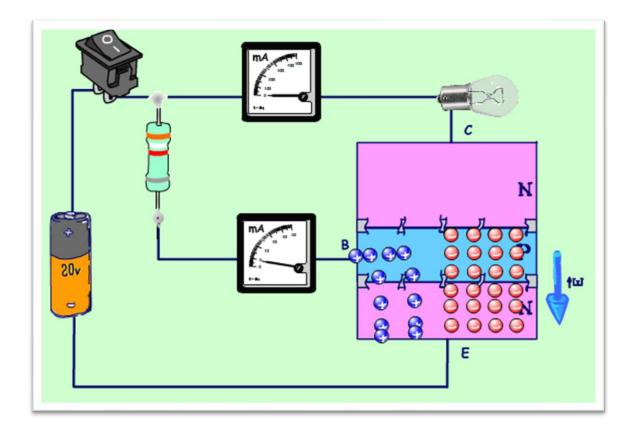
Ao romper a zona de depleção base emissor as cargas negativas presentes no cristal tipo N se deslocam no sentido contrário ao campo elétrico, invadindo a região da base e neutralizando a zona de depleção base coletor que também é rompido, veja que a região da base é mais fininha, então as cargas negativas invadem com mais força a região do coletor e uma grande corrente é estabelecida.
