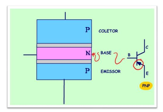
Mas, se existe um empilhamento NPN, também existe um empilhamento PNP, agora a base é o cristal N, o cristal do meio, eu vou usar o tipo NPN para explicar o funcionamento do transistor, a teoria é a mesma para o PNP, mas com as correntes circulando no sentido contrário, por isso a seta no emissor do PNP está ao contrário.
