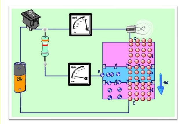
Observe que uma pequena corrente entre a base e o emissor desencadeou uma grande corrente coletor emissor, você pode ver isso nos ponteiros dos amperímetros.
