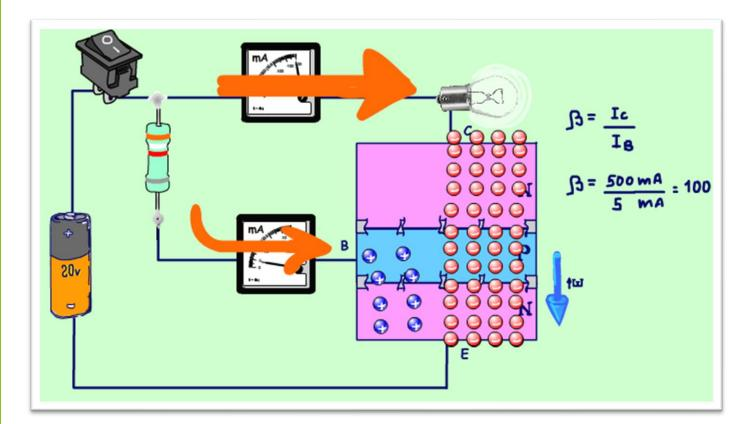
Então podemos resumir o funcionamento do transistor dizendo que ele é um componente em que uma quena corrente aplicada na base controla uma corrente grande no coletor.
