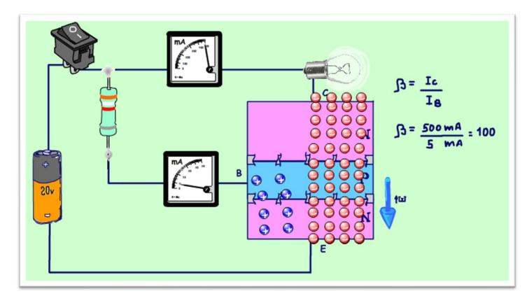
O ganho de corrente é a razão entre a corrente de saída dividido pela corrente de entrada, nesse nosso exemplo será igual a 500mA dividido por 5 mA, isso dá 100, como é a razão entre duas grandezas iguais o resultado não tem dimensão é só um número e pronto, o ganho beta é 100, simples assim.
