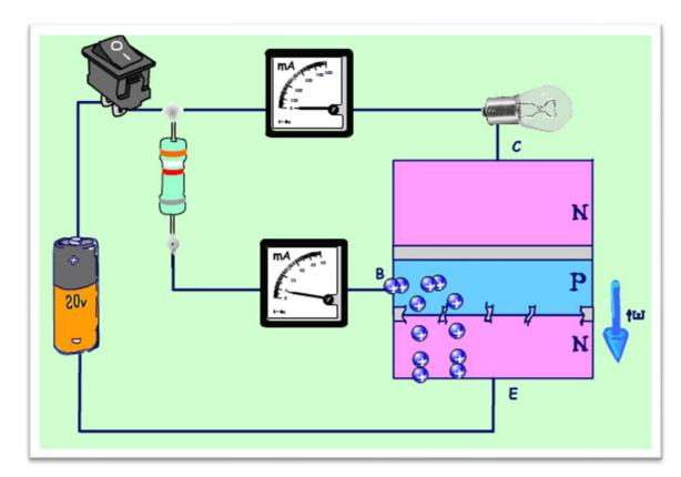
Com a resistência ligada na base, a junção base emissor fica polarizada diretamente o vetor aponta no sentido do cristal P para o cristal N, a zona de depleção base emissor é rompida e as cargas positivas começam a circular da base para o emissor exatamente como acontecia no diodo, o efeito é exatamente o mesmo.
