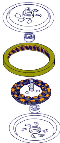
Veja na figura como o motor de ventilador de teto é construído, a grande diferença em relação aos motores de indução normais é que o rotor é montado externamente, isso para facilitar a fixação do motor no teto, quem roda é a parte externa do ventilador, veja na figura que as bobinas estão montadas na parte interna do motor o rotor está montado por fora.
