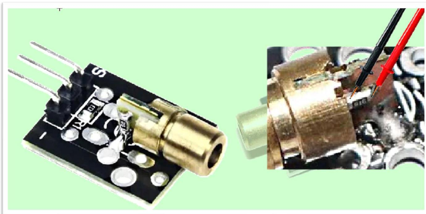
Mas tem uma solução para esse probleminha, é só olhar o valor da resistência em série, ou medir com uma ponteira bem fininha, veja outro detalhe é a posição da resistência, a de 31 OHM está na vertical.
