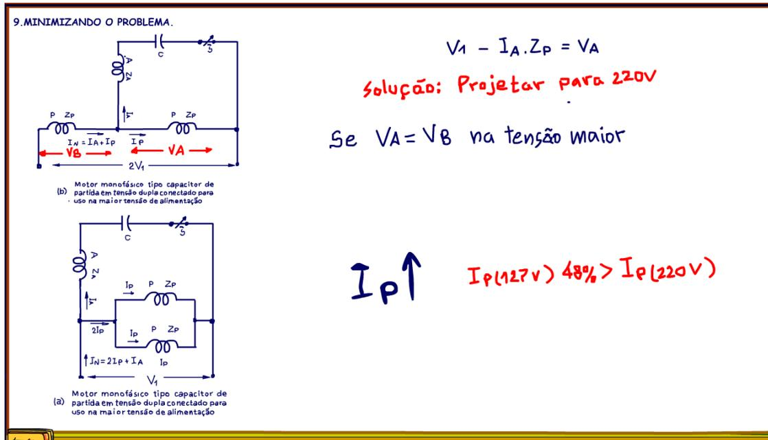
Para minimizar esta redução no torque de partida, estes motores são, normalmente, projetados em 220V, conseqüentemente, quando alimentado em 127V o torque de partida é muito maior do que o necessário para acionar a carga (até 48% superior).
