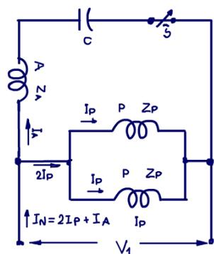
(a) Motor monofásico tipo capacitor de partida em tensão dupla conectado para uso na maior tensão de alimentação
