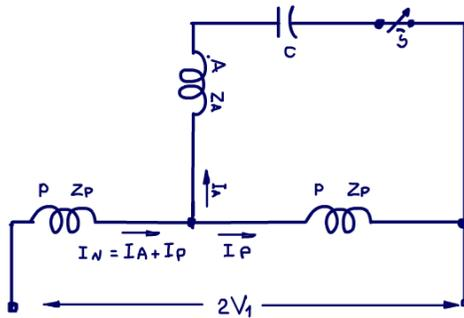
(b) Motor monofásico tipo capacitor de partida em tensão dupla conectado para uso na maior tensão de alimentação
