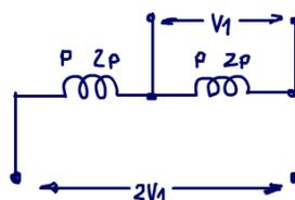
Nesse caso o enrolamento principal tem duas funções, primeiro atua como o enrolamento principal do motor, segundo atua com autotransformador reduzindo a tensão para o enrolamento auxiliar, mas será que a tensão vai se dividir exatamente em dois e termos sobre a bobina auxiliar exatamente o valor de  $V_1$ , a menor tensão?
