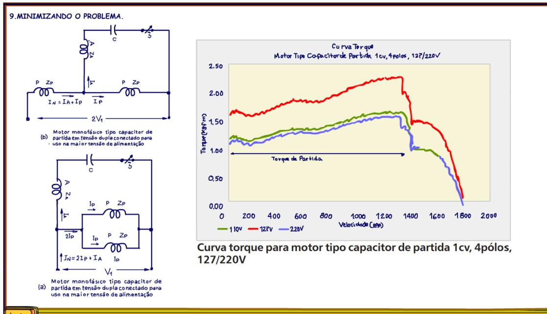
A figura ao lado mostra curvas de torque obtidas através do método de medição direta (IEEE 114, 2002) para um motor de 1cv, 4pólos, tipo capacitor de partida, 127/220V. Como pode ser observado, fica evidente as diferenças no torque de partida quando o motor é alimentado na maior tensão de alimentação (220V) e na menor tensão de alimentação (110V e 127V).
