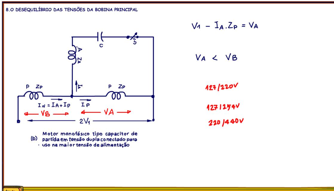
Mas, não é só isso, observe que a tensão na segunda bobina principal vai ficar menor do que a tensão na primeira bobina, isso se agrava no Brasil onde a tensão não exatamente o dobro da tensão menor, no Brasil as tensões monofásicas padronizadas são, 127V, 220V, 254V e 440V conforme resolução da ANEEL n° 501. Isto implica que, além dos motores em tensão única, estão disponíveis os motores monofásicos em tensão dupla com as seguintes tensões de alimentação: 127/220V, 127/254V e 220/440V.
