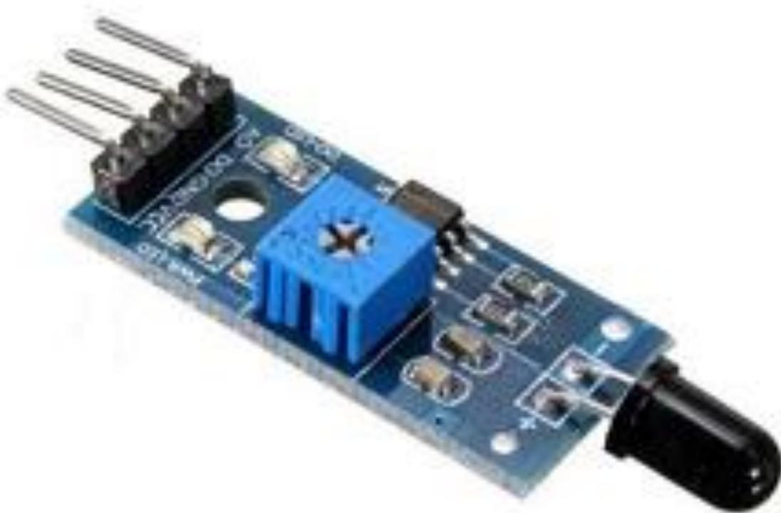
Este é o sensor de chama mais popular para aplicações simples com o Arduino, na verdade este é um módulo para detecção de radiação infravermelho (IR) na faixa de 760 a 1100 nm e não é um shield do Arduino podendo ser usado com qualquer microcontrolador, ou sozinho mesmo!
