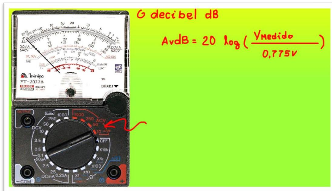
Agora observe bem a escala de decibel no instrumento, veja o cursor, está posicionada na escala AC de 10V, sim, o decibel é usado para medir AC, sinais dos amplificadores principalmente e na escala de 10V, para outras escalas a precisão cai e você deverá aplicar um multiplicador, na verdade é um somador, como descreve no manual da Minipa.
