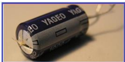
FIGURA 8: CAPACITOR COM FALHA.
