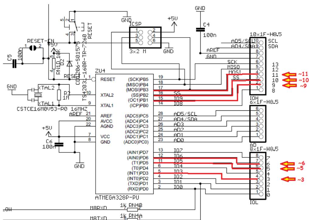
A tabela abaixo mostra a relação entre os pinos do microcontrolador o temporizador que controla aquele pino e o pino da placa Arduino UNO. A frequência que aparece na descrição é referente a frequência normal de operação!
