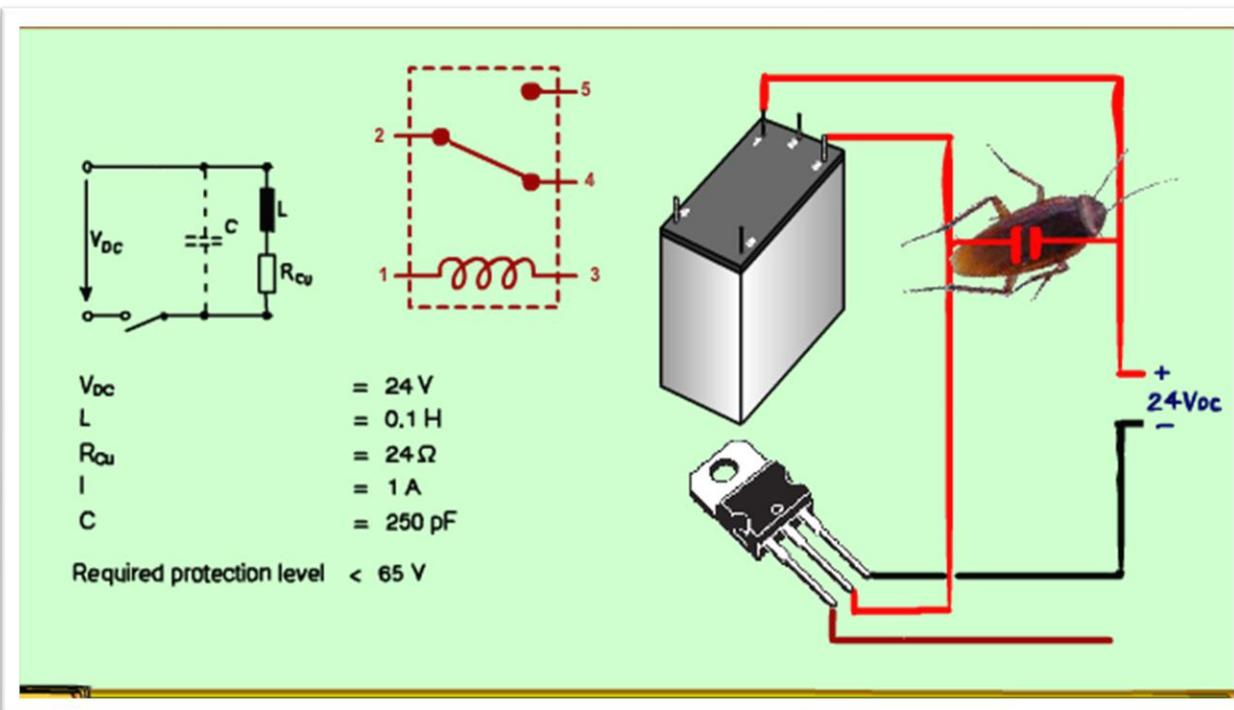
Uma forma bem simples de ver esse fenômeno é pensar que a energia armazenada no indutor vai ser descarregada no capacitor existente no circuito.
