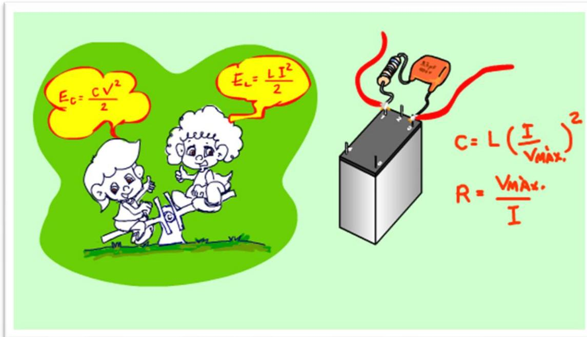
Você viu nesse tutorial que sim, um snubber pode ser colocado em paralelo com a bobina do relé, você viu como calcular a tensão reversa, o capacitor e o resistor do snubber para corrente contínua, olha o resumo na figura, claro que tem outras formas de controlar a tensão reversa, mas isso fica para outro tutorial.
