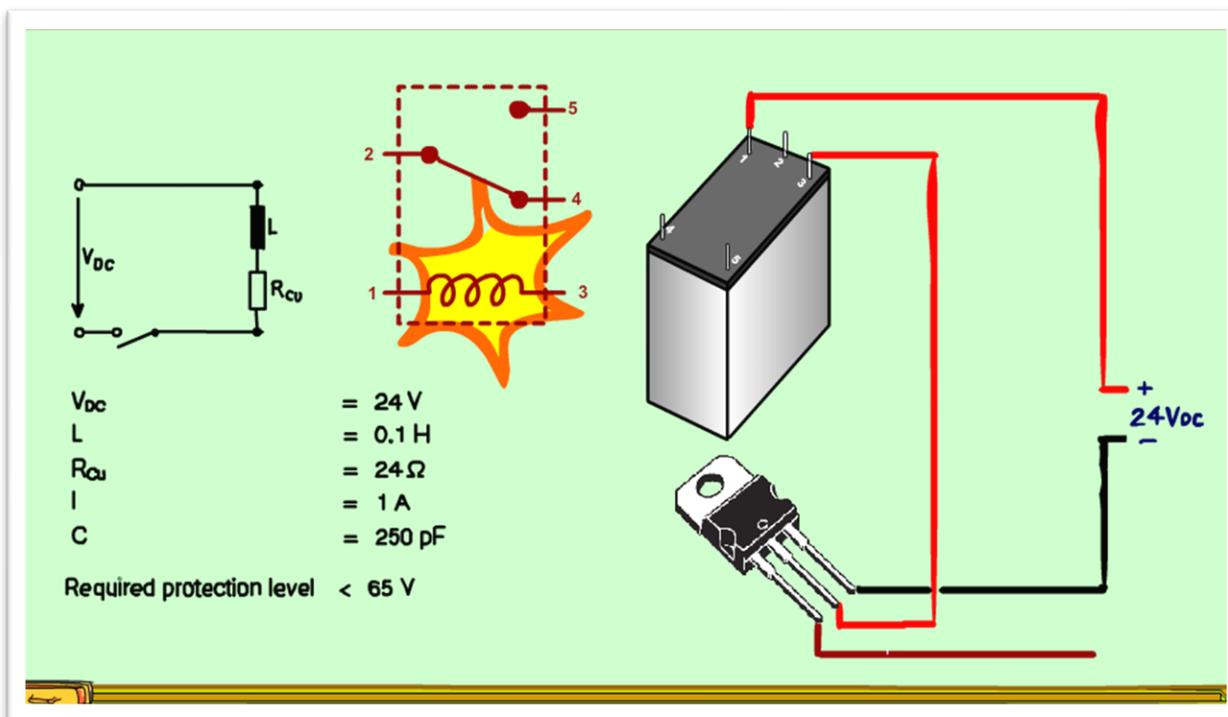
Quando o relé é desligado a energia armazenada no indutor tem que ser descarregada, qual a consequência disso?
