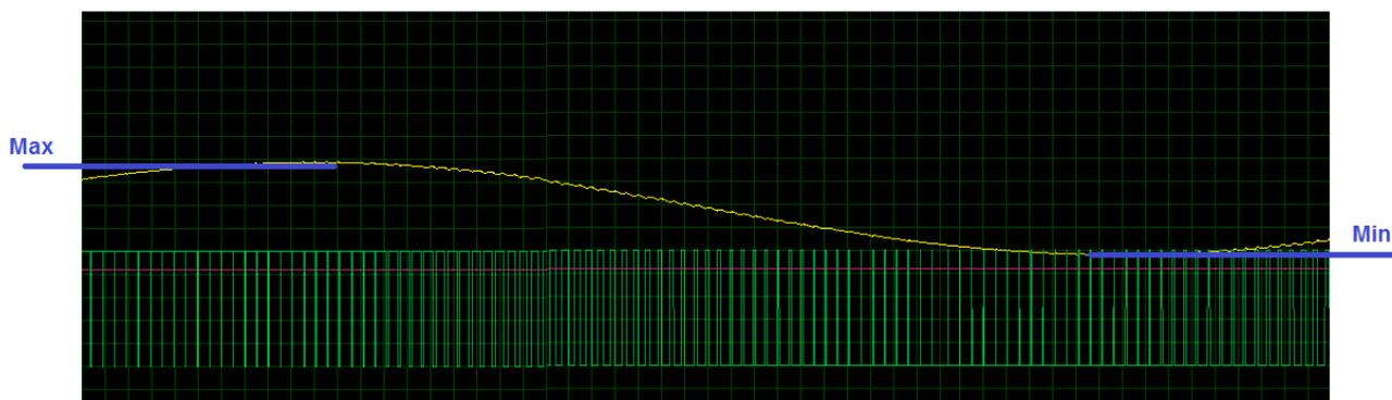
O ângulo de passo mínimo é de 5,7375 Graus, assim cada passo do PWM ajusta o valor da amplitude de forma a ajustar o valor da senóide a cada 5,7375 graus.
