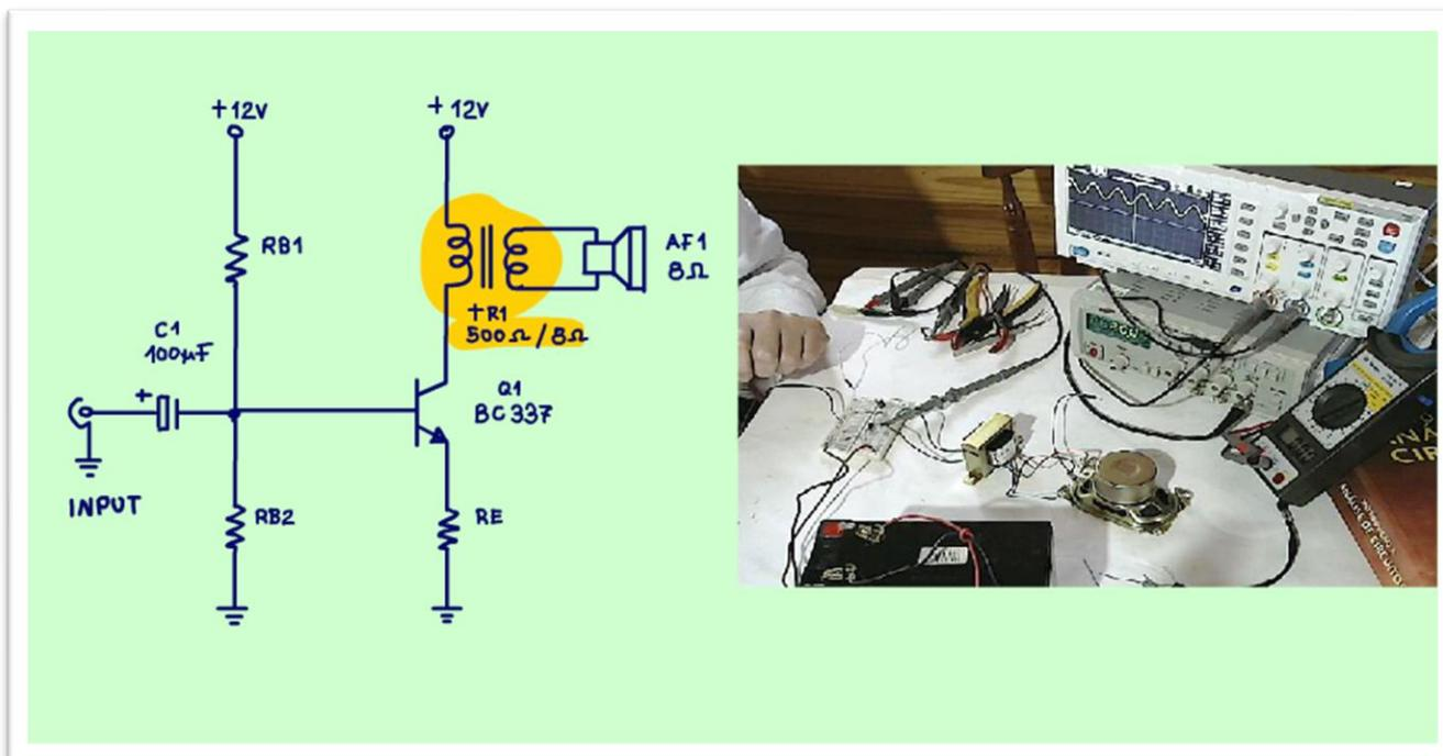
O circuito do tutorial passado “AMP- Amplificador classe A com transformador na prática” é mostrado na figura, naquele tutorial eu montei o amplificador classe A com um transformador comercial, um transformador feito especialmente para essa aplicação, e o circuito funcionou perfeitamente, se você não viu aquele tutorial fantástico, então dê uma olhadinha, ele está na descrição de vídeo.
