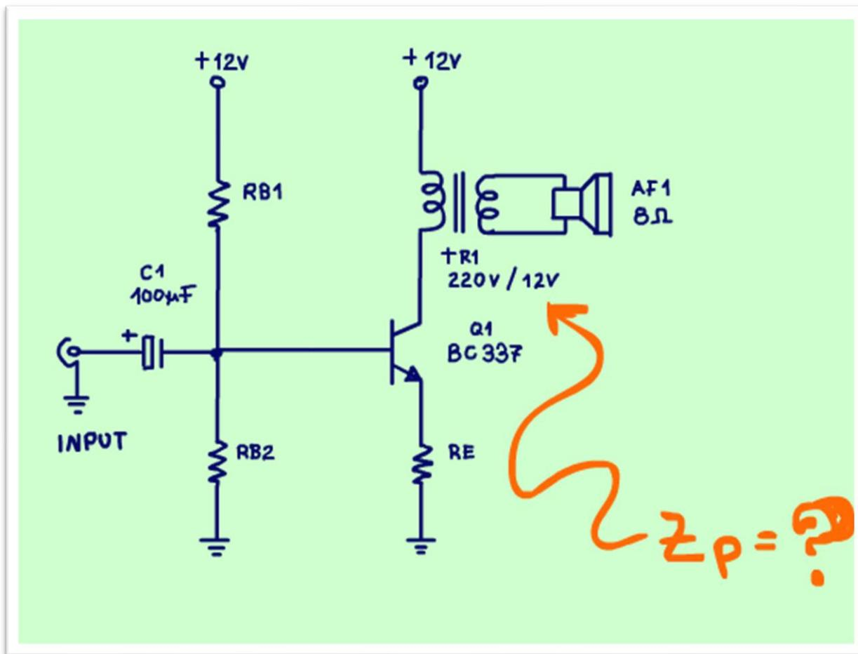
A principal mudança é o transformador, quando você compra um transformador feito para essa função a impedância do primário é bem definida, no transformador do tutorial passado essa impedância era de 500 OHM, tava lá, escrito no transformador, mas nesse transformador não fala nada da impedância do primário, como fazer?
