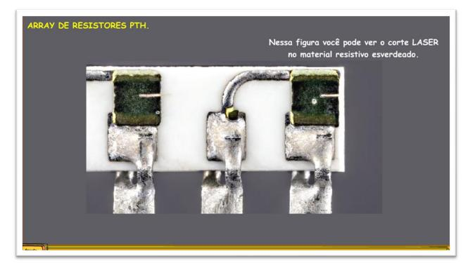
Este é um arranjo de resistores montados em linha, ou SIL, onde todos os terminais são dispostos em linha reta.
