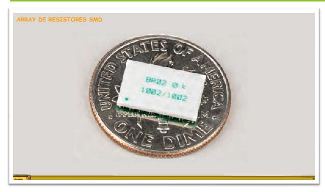
Agora vou mostrar como são montados os array de resistores para montagem do tipo SMD, aquelas montadss direto sobre a ilha, sem furo.
