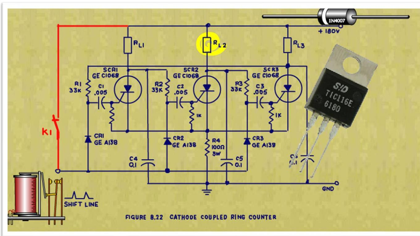
Essa chave pode ser os contatos de um relé e tudo fica automatizado, se você usar somente dois SCRs você pode fazer um circuito do tipo toggle, para ligar e desligar um motor a cada toque da chave.
