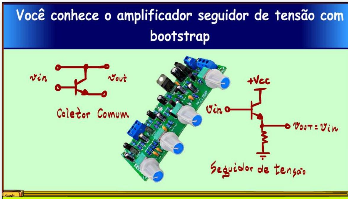
Nesse tutorial eu mostrar como usar o capacitor de bootstrap para melhorar o amplificador seguidor de tensão muito usado na entrada dos amplificadores e nos amplificadores de potência.
