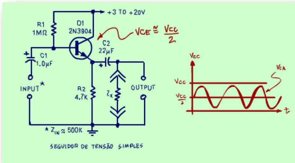
O amplificador de coletor comum ou seguidor de tensão pode amplificar sinais analógicos acoplados a base do transistor se o transistor for polarizado para um valor quiescente de cerca de metade da tensão de alimentação, como você já ouviu mais de uma vez nesse canal amalucado.
