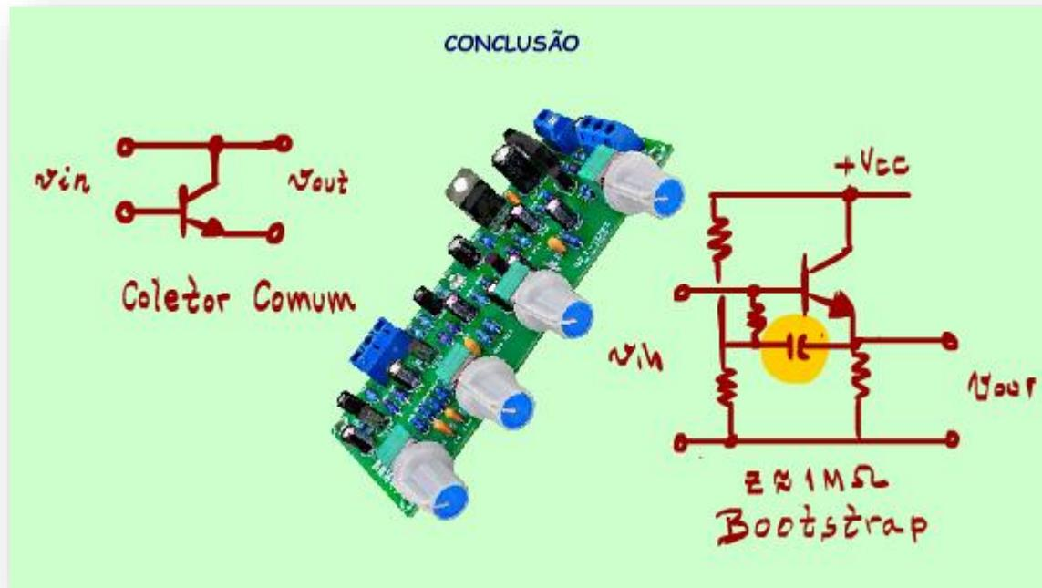
Você viu que para estabilizar o amplificador seguidor de tensão a impedância de entrada cai muito, então é só usar o capacitor de bootstrap para aumentar essa impedância e se o circuito tiver a configuração Darlington a impedância de entrada aumenta muito mais ainda e você pode utilizar todo esse conceito nos amplificador de potência.
