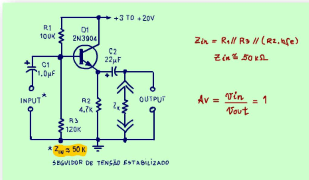
O circuito da figura é um pouco melhor porque é independente do ganho  $h_{fe}$ . As resistências  $R_1$  e  $R_3$  formam um divisor de tensão.
