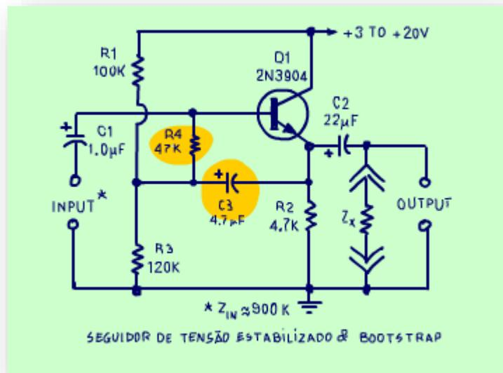
A impedância de entrada pode ser muito incrementada acrescentando-se o capacitor C3, chamado de capacitor de bootstrap, ou reforço, que junto com R4 vão fazer o milagre da multiplicação da impedância de entrada.
