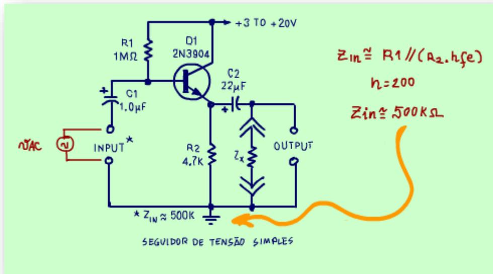
Nesse circuito a base é polarizada pelo resistor R1 de 1 MOHM conectado entre a base o positivo da fonte de alimentação, a impedância de entrada é o paralelo de R1 com a resistência de emissor de 4,7 KOHM refletida na base multiplicada pelo ganho do transistor, o hfe.
