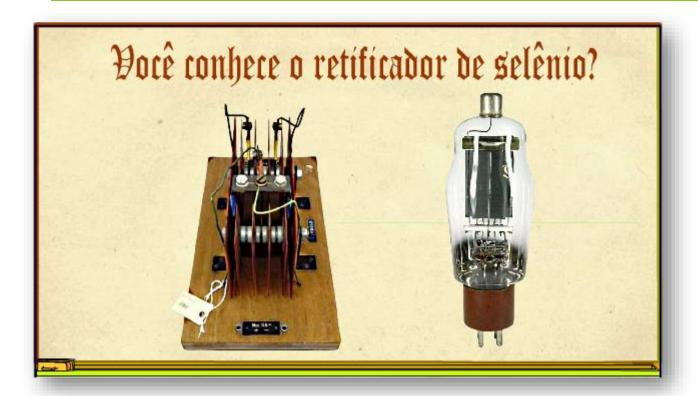
O retificador de selênio foi muito usado no passado, ele veio substituir as válvulas termiônicas, eram bem mais eficientes, e funcionavam usando uma junção semicondutora.
