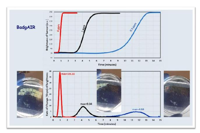
O BadgAIR é pré-calibrado (na fábrica) com uma curva padrão que relaciona a taxa calculada de alteração do brilho do sensor com a concentração correspondente de gás tóxico. Assim, o BadgAIR determina a concentração de gás tóxico em uma amostra de ar desconhecida comparando a resposta do sensor químico a concentrações conhecidas do gás tóxico.
