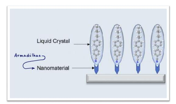
O fundamento dessa tecnologia se baseia em construir armadilhas, essas armadilhas possuem um desenho que permite que somente um tipo de molécula se encaixe, é uma espécie de armadilha para as moléculas tipo o sulfeto de hidrogênio H2S, um gás altamente tóxico e rasteiro, ele é mais denso doque o ar.
