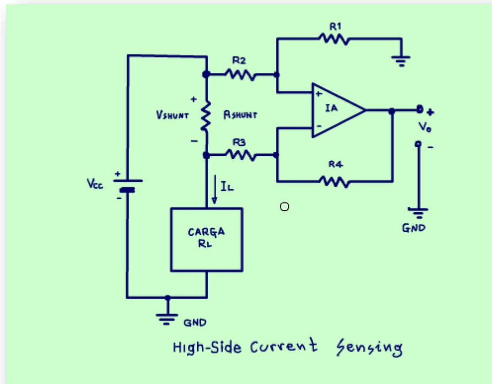
O circuito da figura mostra como colocar a resistência shunt do sensor de corrente em série com o positivo da fonte para medir a corrente, para pegar a medição da corrente é usado um amplificador de instrumentação, um amplificador diferencial.
