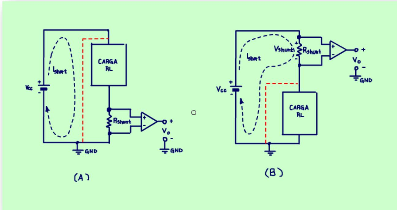
Um segundo benefício é a detecção do curto-circuito na carga em relação ao terra, veja na figura "A" com a resistência shunt aterrada, a corrente de curto-circuito na carga em relação ao terra não passa pela resistência shunt.
