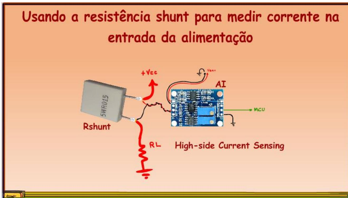
Existem duas formas de montar a resistência shunt, o sensor de corrente, uma conectada ao terra, a mais usada, e outra conectada em série com o positivo da fonte, é essa forma de montar que vamos ver nesse tutorial.
