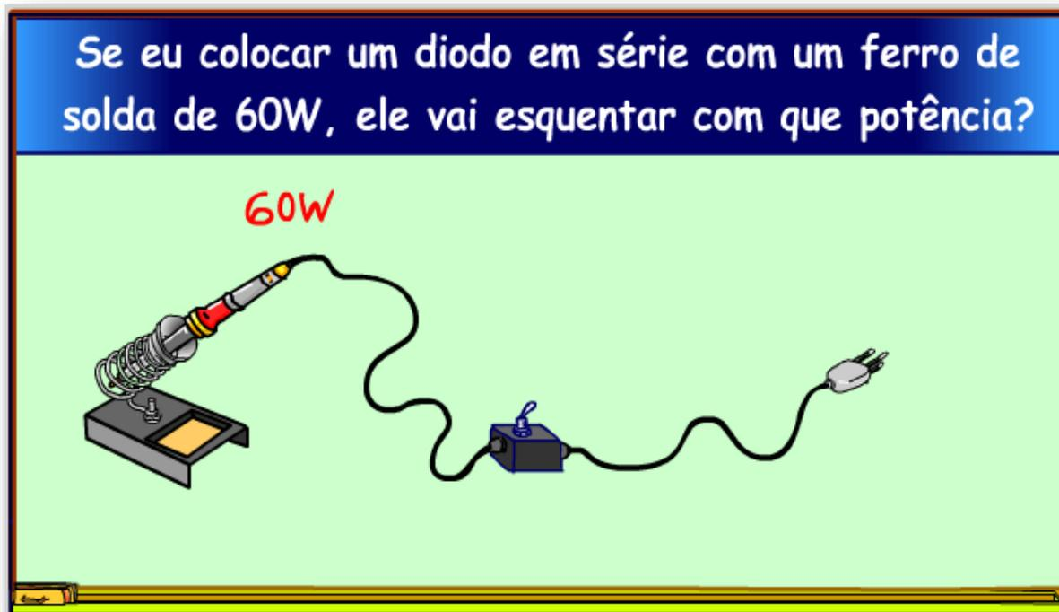
Todo mundo já viu essa dica para diminuir a potência do seu ferro de solda, ou ter duas potências de uma forma bem simples, é só montar o circuito da figura uma chave e um diodinho 1N4007 numa caixinha com a chave e pronto, temos uma estação de solda de dois estágios.
