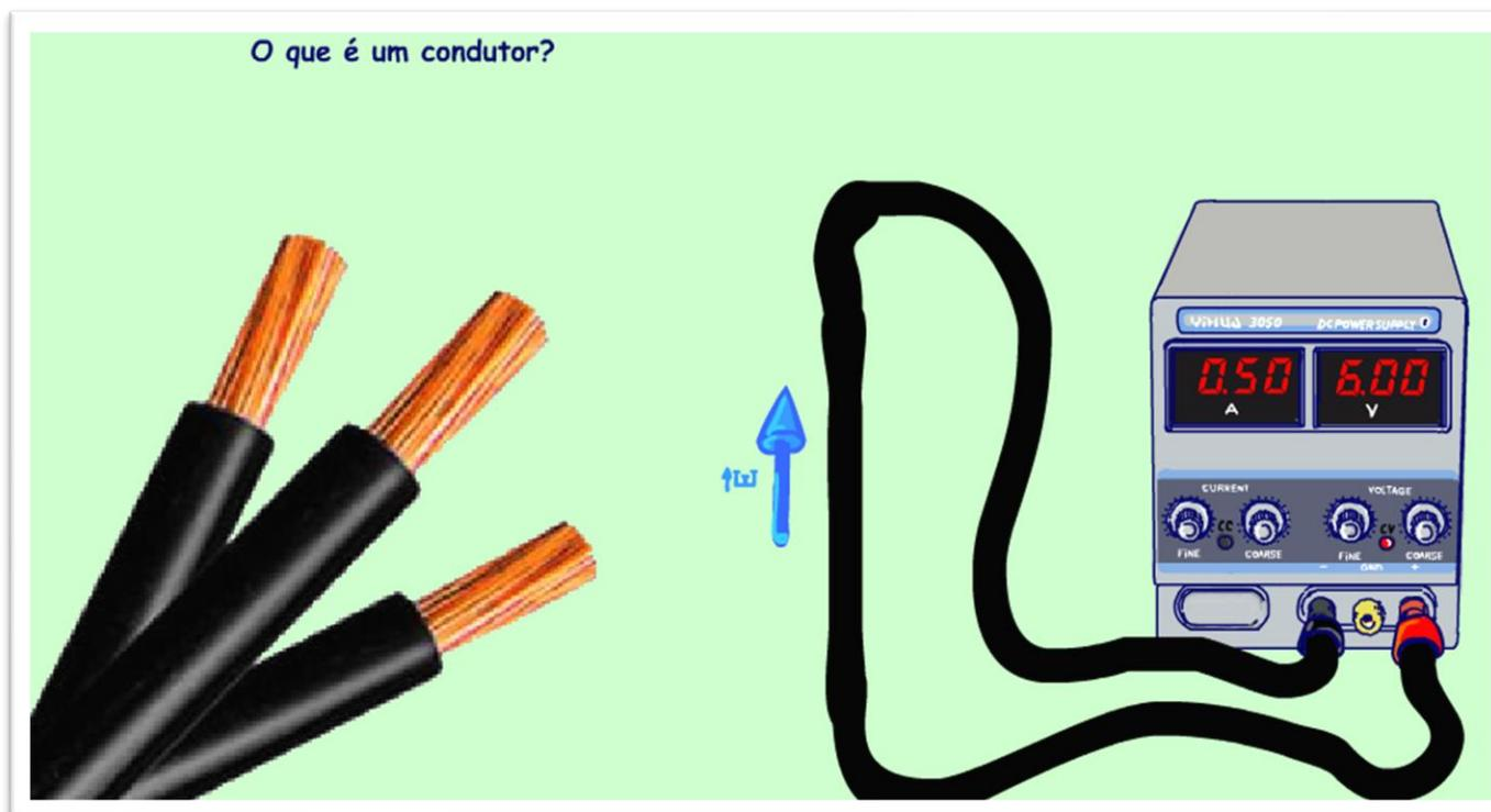
Uma explicação muito prática é pensar que a fonte de energia elétrica gera uma espécie de campo de força que impulsiona as cargas elétricas no condutor, esse campo exerce uma pressão elétrica dentro do condutor, o sentido dessa pressão é por convenção do polo positivo para o polo negativo e é representado por um vetor, a seta indica o sentido de deslocamento das cargas elétricas e o tamanho do vetor indica a intensidade desse campo elétrico.
