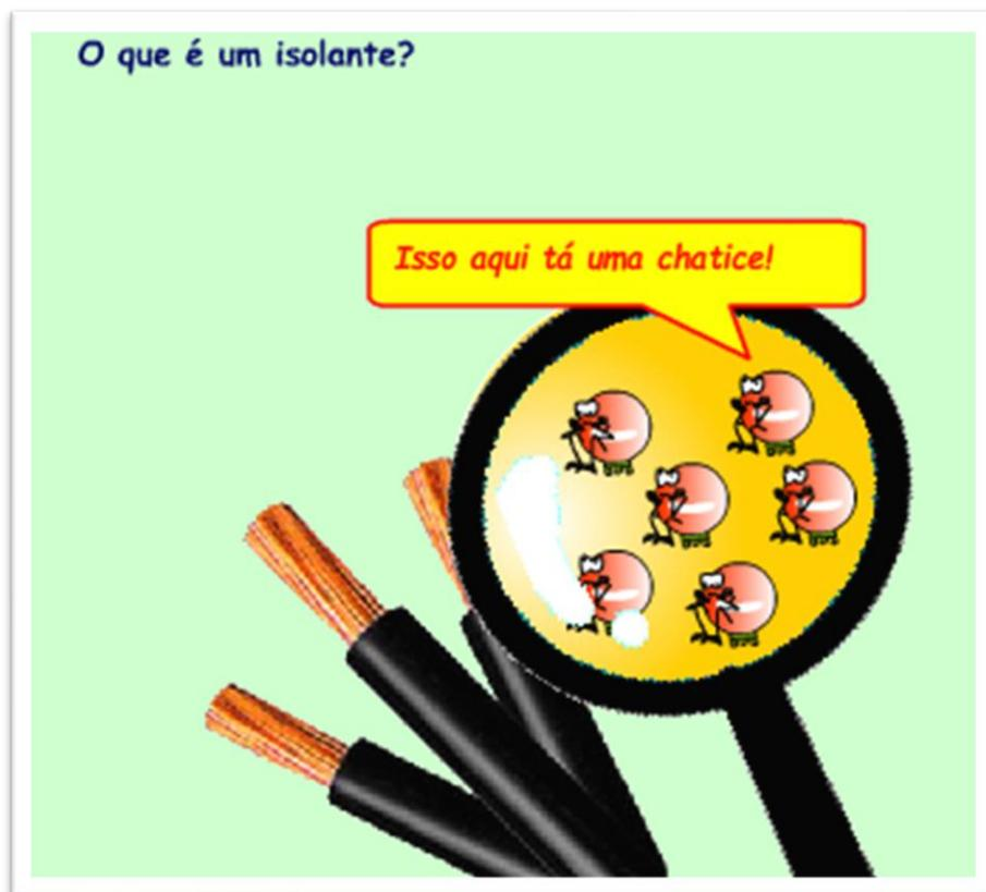
O material isolante possui uma estrutura fixa, rígida então, não têm elétrons livres, não permitindo a passagem da corrente elétrica.
