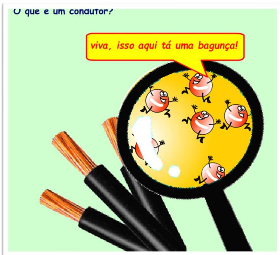
O cobre e os metais são materiais especiais, na sua estrutura atômica está cheia de elétrons livres, são elétrons que estão fracamente ligados ao núcleo e ficam zanzando pelo condutor, os elétrons possuem cargas elétricas negativas e eles serão os responsáveis pela corrente elétrica no condutor.
