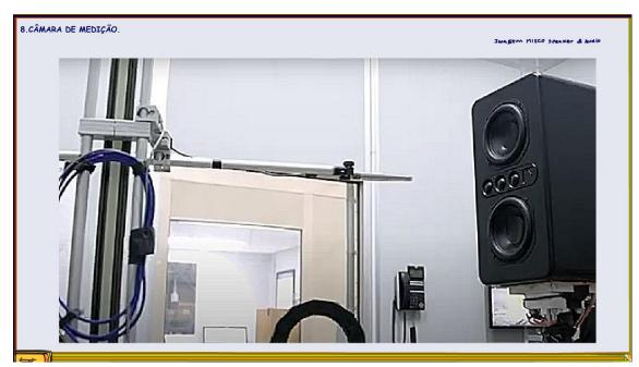
Claro que existem câmeras especialmente desenhadas para a essa medição, o sinal de 1W é gerado automaticamente varrendo todo o espectro de frequência audível, a medição é feita por instrumentos especiais, e todo o dado é processado para determinar a frequência e a sensibilidade do alto-falante ou caixa de som.
